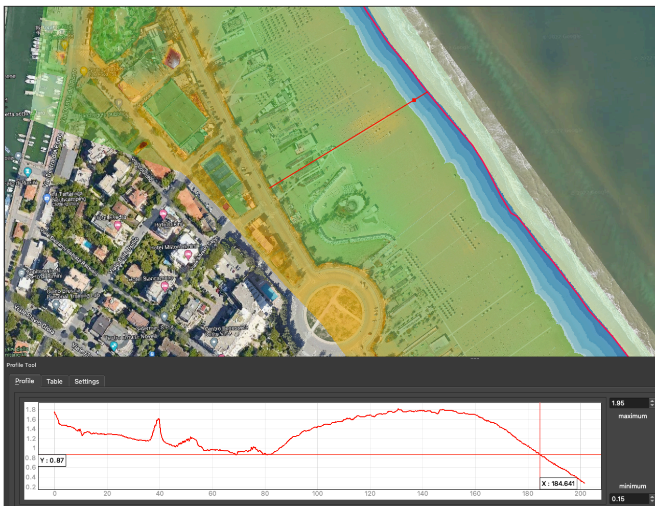
Figura 11 transetto topografico derivato da Lidar - Bagno 8 Rimini Sud – Allagamento con evento di TR = 1 anno
