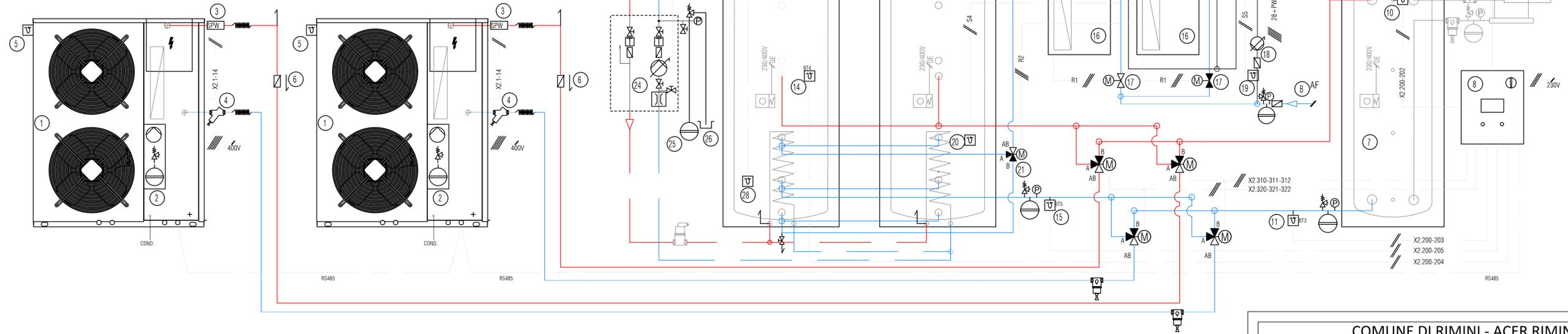
Impianto con Energygal Inverter/AW PRO AT in cascata per riscaldamento/raffreddamento e sanitario con più Vitotrans 353 PBxA in abbinamento ad impianto solare termico.
