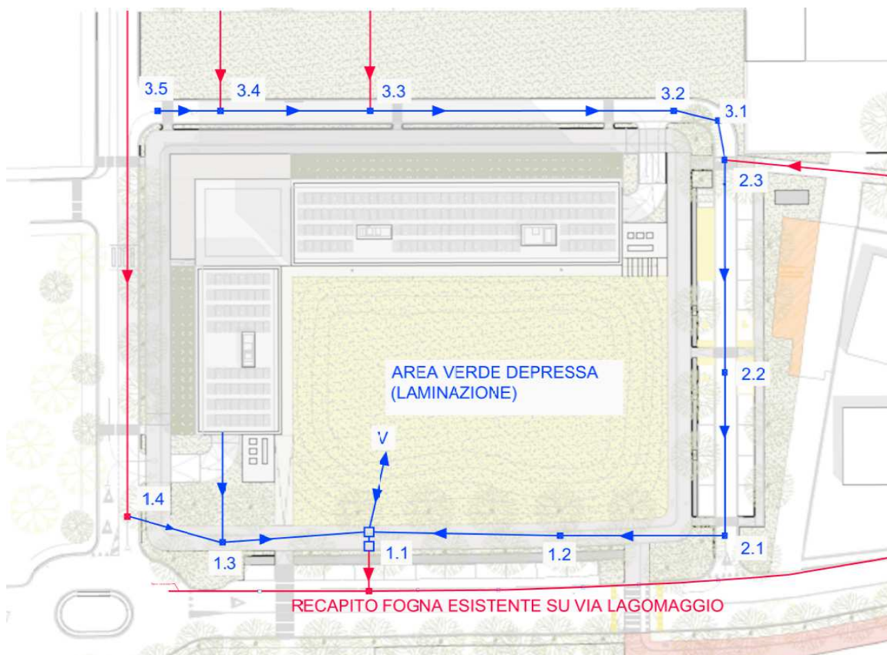
Figura 4: Schema delle reti fognarie di urbanizzazione (in rosso le reti esistenti e in blu le reti di progetto)
