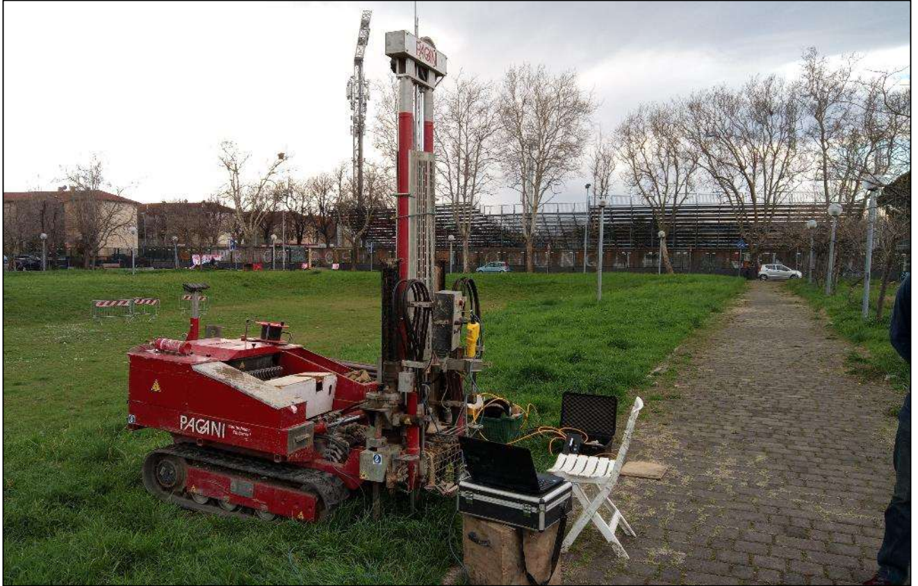
Figura 12 Penetrometro Pagani TG63/200 nel corso della prova
