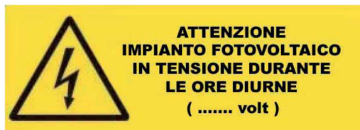
Figura 13.2 – Cartello di sicurezza per un impianto fotovoltaico collegato alla rete del distributore
