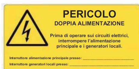
Figura 13.1 – Cartello di sicurezza per un impianto fotovoltaico collegato alla rete del distributore
